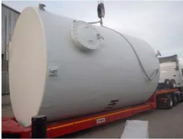
Zbiornik pionowy wzmocniony włóknem szklanym
