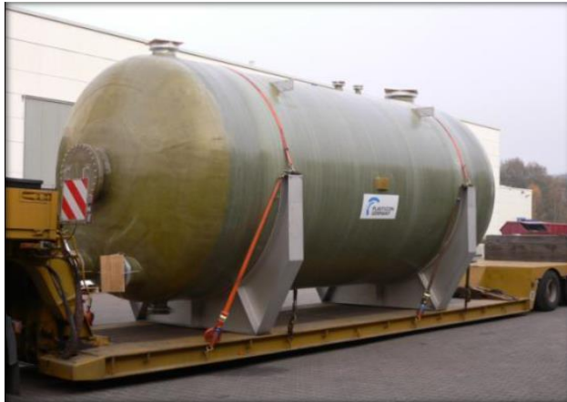
Zbiornik poziomy na agresywne medium wzmocniony włóknem szklanym
