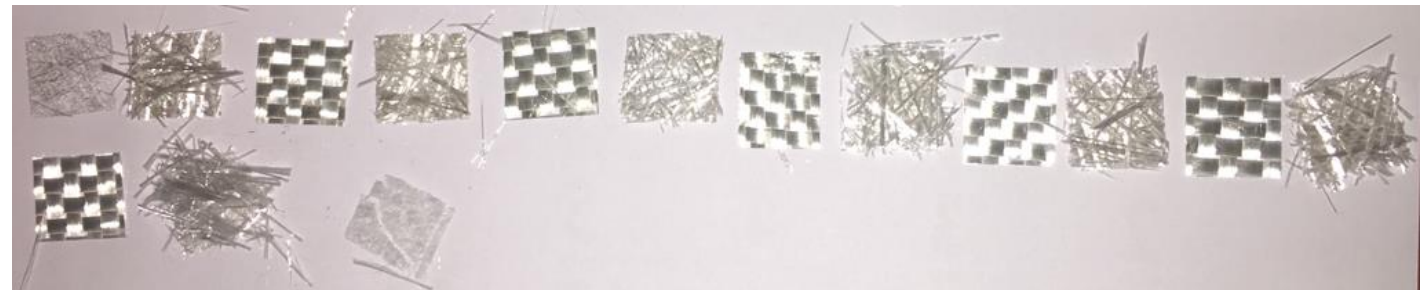
wyodrębnione warstwy wzmocnień szklanych z laminatu
